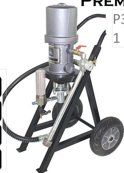
Безвоздушный окрасочный аппарат с пневматическим приводом PremJet P301 с передаточным соотношением 30:1. Материал частей, контактирующих с жидкостью: Углеродистая сталь, легированная сталь, нержавеющая сталь марок 304, 440 и 17-4 PHB, цинковое и никелевое покрытие, ковкий чугун; карбид вольфрама, ПТФЭ; Кожа. Распыляемые ЛКМ - эпоксиды, Алкиды, Уретаны, Антикоррозионные, Кровельные, Гидроизоляционные покрытия, Финишные и грунтовочные покрытия.
